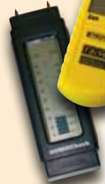
Feuchtemessgeräte für Oberflächen- und Materialfeuchte (Putz)
